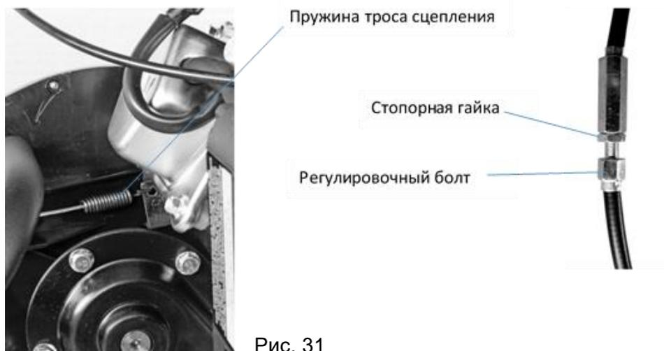
1. Затяните стопорную гайку.
